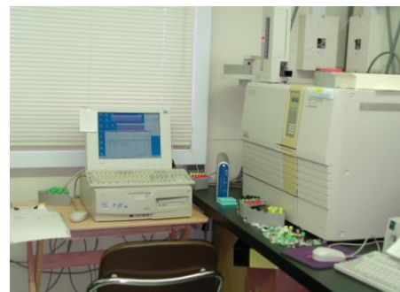
ガスクロマトグラフ分析方法により、 測定対象物質の定量
