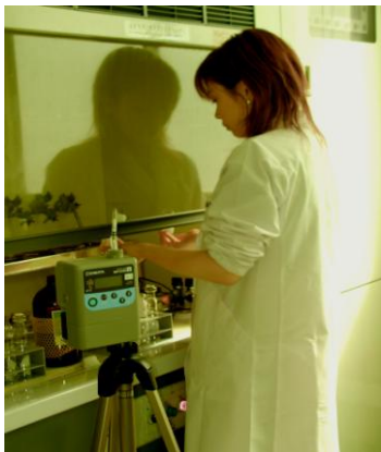
測定用のミニポンプで有機溶媒を吸引 (上はA測定、下はB測定)
