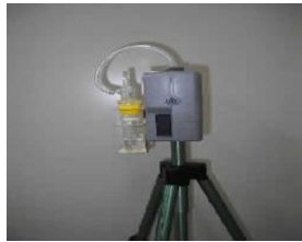
液体捕集方法(インピンジャー)
