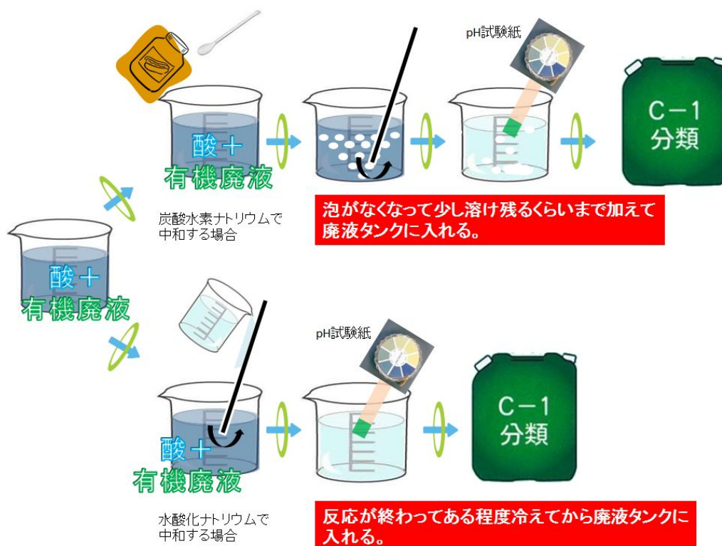
図 有機廃液が混入した酸廃液の中和処理
